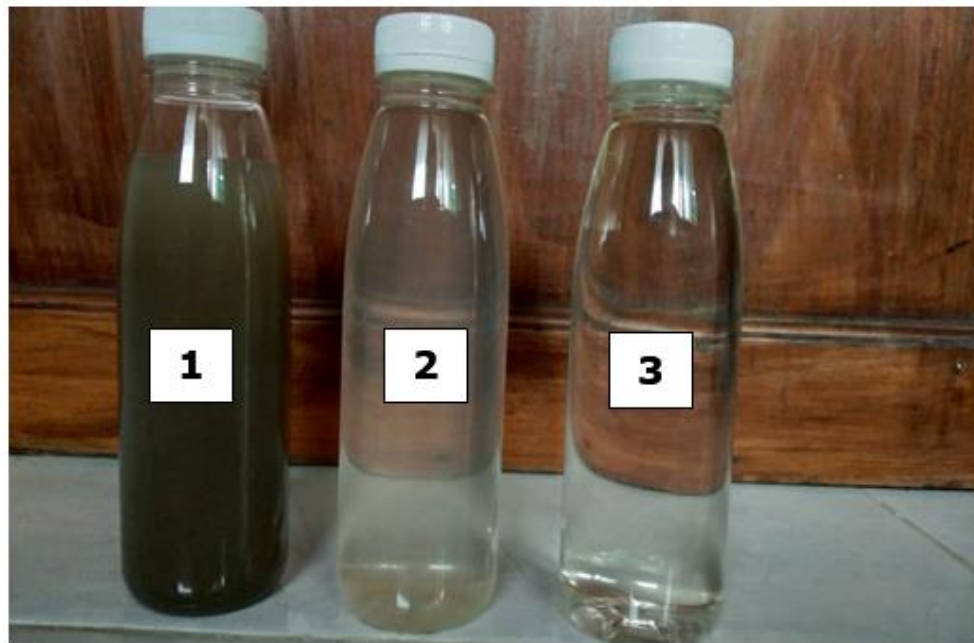
Gambar 4. Hasil akhir proses penjernihan air dengan menggunakan MBG
